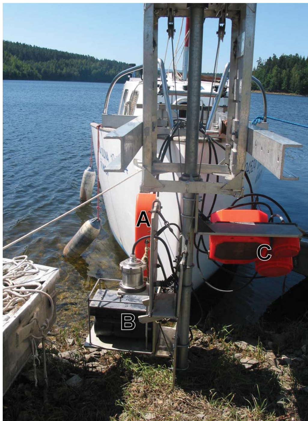
Obr. 4.2.2. Vysilače na přídi výzkumného plavidla. A: Eliptický 120 kHz vysílač pro horizontální průzkum, B: Akustická kamera Didson, C: Vysílač pro vertikální snímkování: 38, 120 a 400 kHz. (foto: archiv FISHECU).
