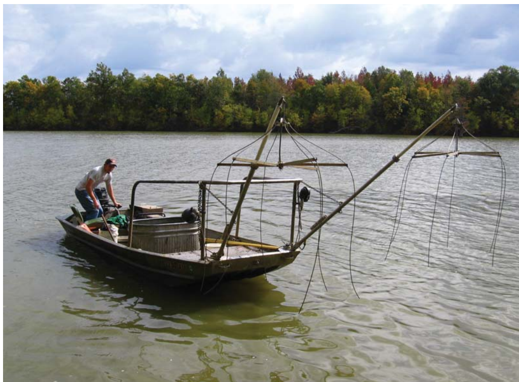
Obr. 6.1.4. Detail elektrolovné lodě s bezpečnostním zábradlím a systémem dvou systémů anod umístěných šikmo před trup lodě (Smith-Root, USA; foto: M. Kratochvíl).
