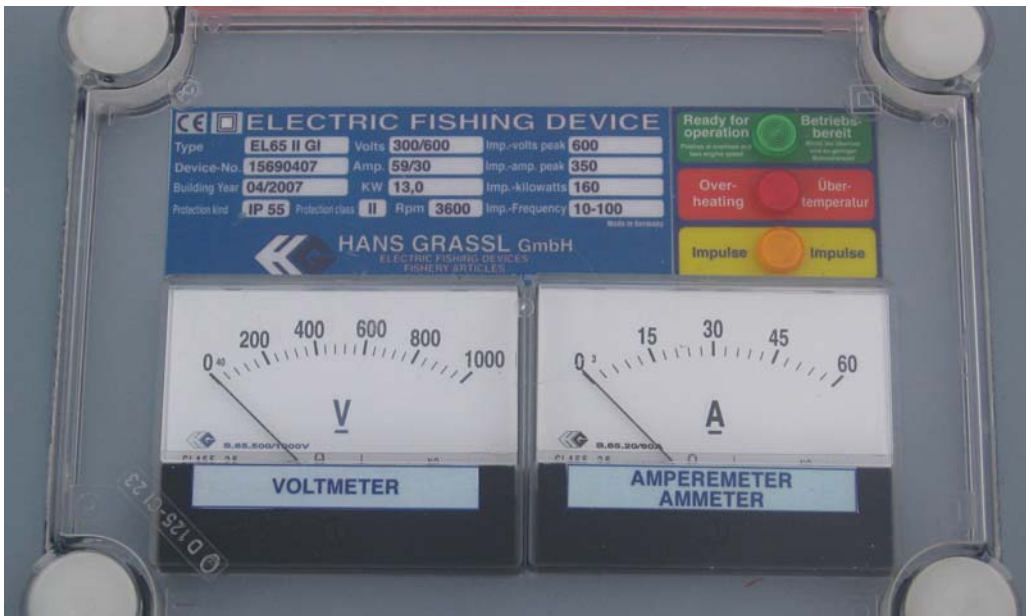
Obr. 6.1.7. Detailní zobrazení voltmetru a ampérmetru pro měření výstupního napětí a proudu z elektrického agregátu (Hans Grassl, Německo; foto: M. Kratochvíl).
