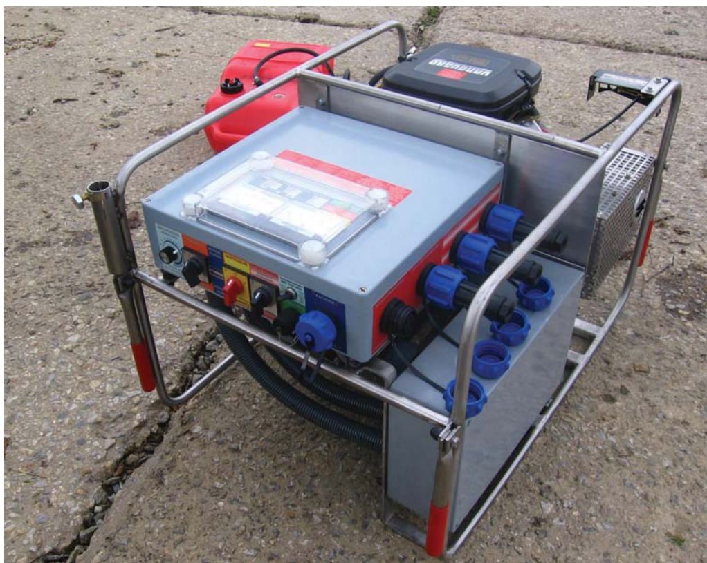
Obr. 6.1.5. Elektrický agregát běžně používaný pro odlovy ryb z lodě v evropských tekoucích i stojatých vodách. Součástí zařízení je i elektrocentrála s výstupy na připojení elektrod a přídatná nádrž na benzin (Hans Grassl, Německo; foto: M. Kratochvíl).
