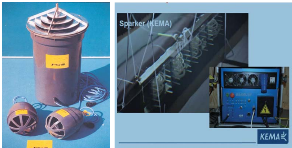
Obr. 5.3.10. Podvodní zvukový projektor a generátor zvuku s řídicí jednotkou (foto: Buijs, 2010).
