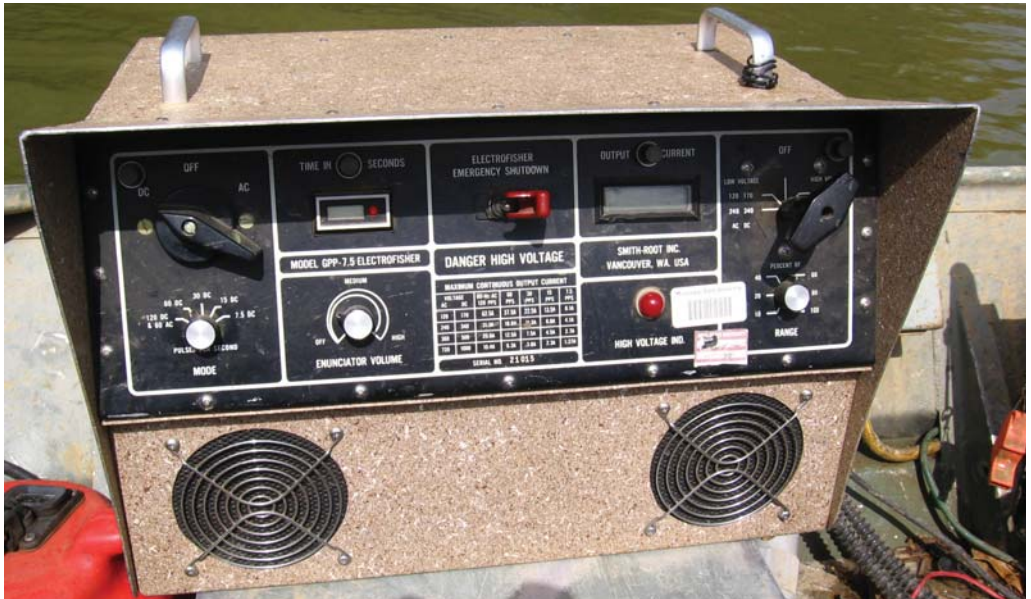
Obr. 6.1.6. Samostatná jednotka elektrocentrály s možnostmi nastavení parametrů typu a výstupu elektrického proudu, nastavení napětí, frekvence, pracovního cyklu atd. (Smith-Root, USA; foto: M. Kratochvíl).
