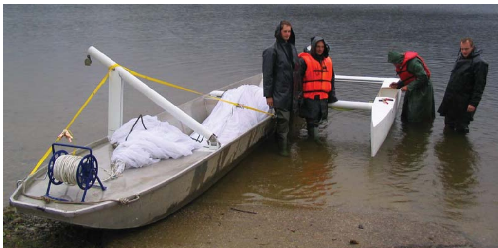
Obr. 6.2.5. Rozdaný adultní košelkový nevod (nahofe), nabírání síťoviny do lodi během košelkování (uprostřed) a loď se speciálními modifikacemi pro zacházení s košelkovým nevodem používaná Hydrobiologickým ústavem BC AV ČR, v.v.i. – patent č. 302159 (dole; foto: FISHECU).
