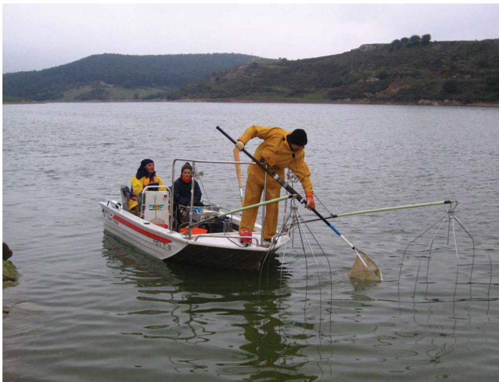
Obr. 6.1.9. Odlovy starších a dospělých ryb probíhají za pomoci elektrolovného systému se dvěma anodami fixovanými před lodí a vybavenými ocelovými lanky, které jsou při odlovu ponořeny ve vodě (foto: M. Kratochvíl).
