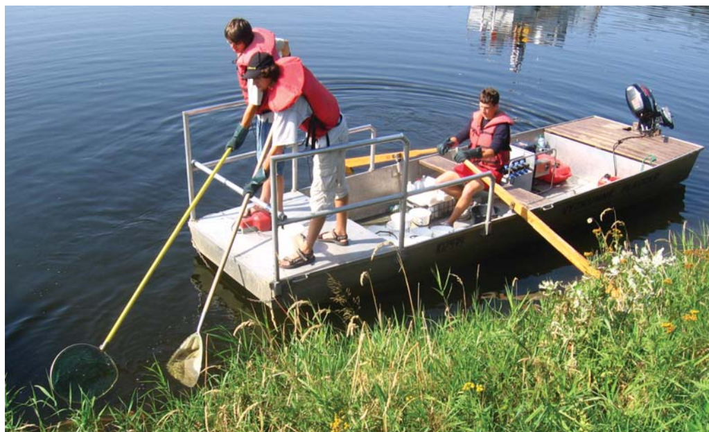
Obr. 6.1.8. Odlov plůdku ryb z lodě pomocí metody bodového vzorkování. Kladná anoda (kruhového tvaru) na konci sklolaminátové tyče je umístěna do vody před loď a zároveň je aktivováno elektrické pole. Veškeré omrácené ryby jsou následně posbírány lovcem s podběrkem (foto: M. Kratochvíl).
